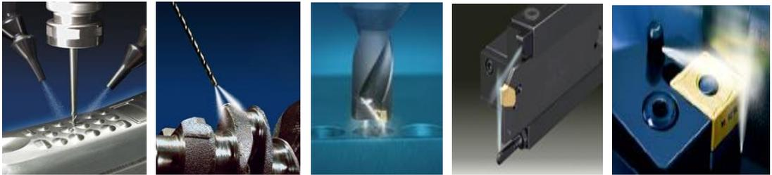
a)外通道供液钻孔 b)内通道供液钻孔 c)内通道供液扩孔 d)内通道供液切断车刀 e)内通道供液外圆车刀
